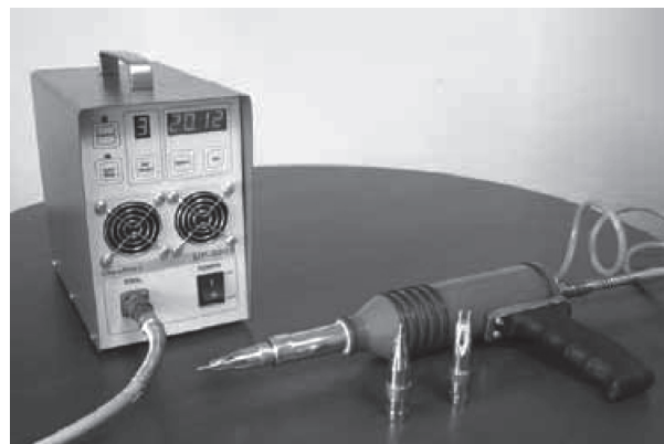
写真3 狭隘部等への小型で軽量の超音波ピーニング装置「UP-500S」
