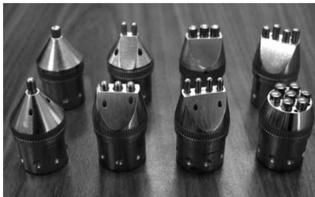
図2 交換可能な一連の作動頭部
