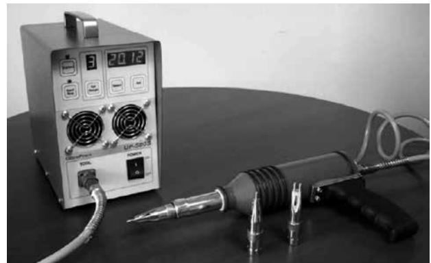
図6 狭隘部等への小型で軽量の超音波ピーニング装置 (UP-500S)
