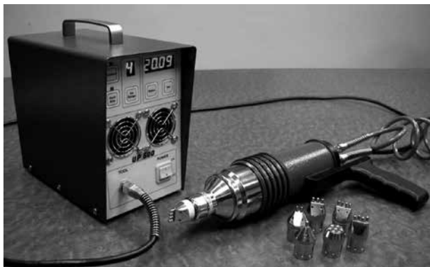
図1 標準的な超音波ピーニングシステム (UP-600)
