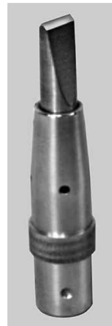
図21 スパッタ除去専用ピンとホルダー
